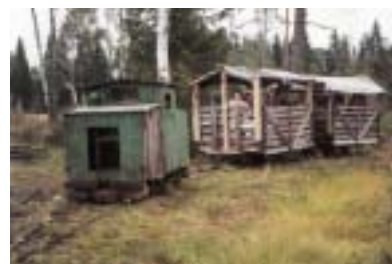
Torvtåget, draget av den bensinelektriska Harteliusloket från 1952, på väg mot fabriken efter en tur ute på mossen. Foto Sven Söderqvist.
